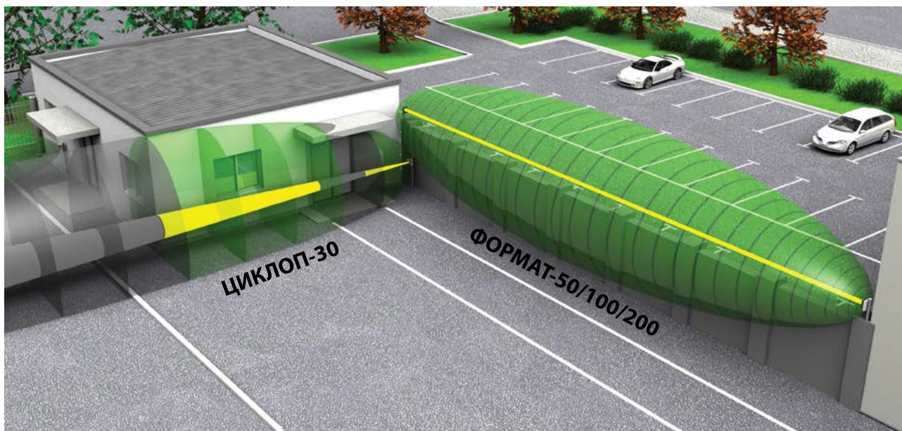
Охрана периметра с помощью комбинированного двухпозиционного извещателя ФОРМАТ-50/100/200 и комбинированного однопозиционного извещателя ЦИКЛОП-30.
